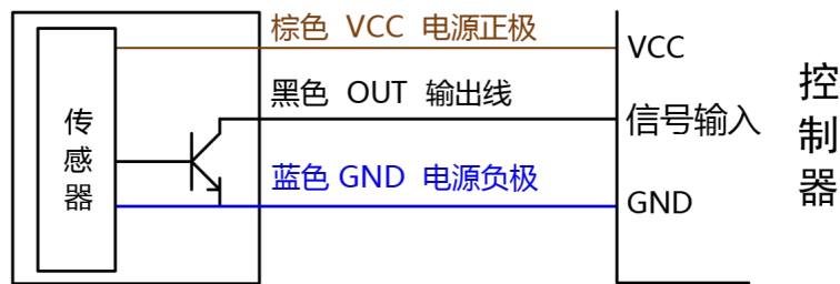
NPN信号输出：连接控制器或MCU的接线方法
