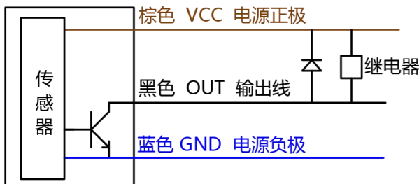
NPN信号输出： 连接继电器的接线方法
